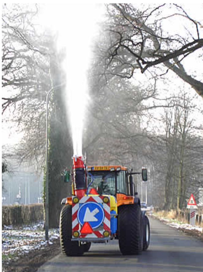
Uitblaas kanon met elektrostaat. M612 voor verticaal bereik tot 35 meter.
